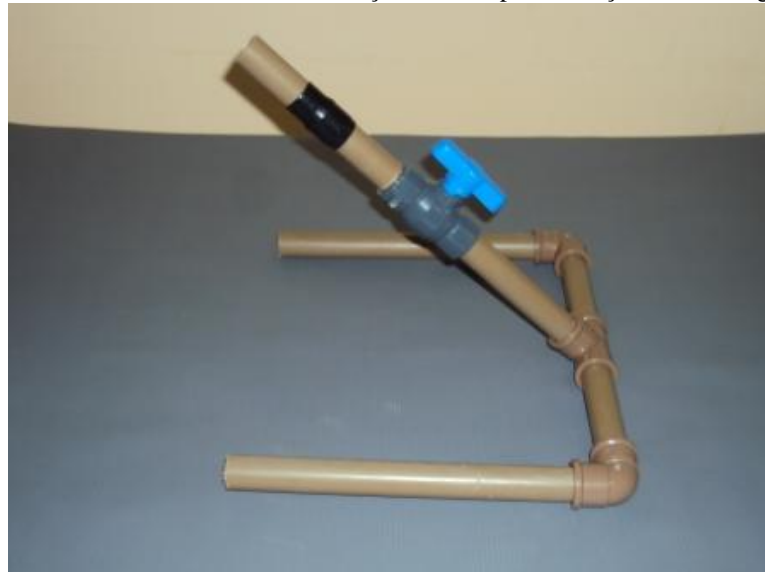
Figura 5.21 - Base mostrando a inclinação correta para o lançamento do foguete.
