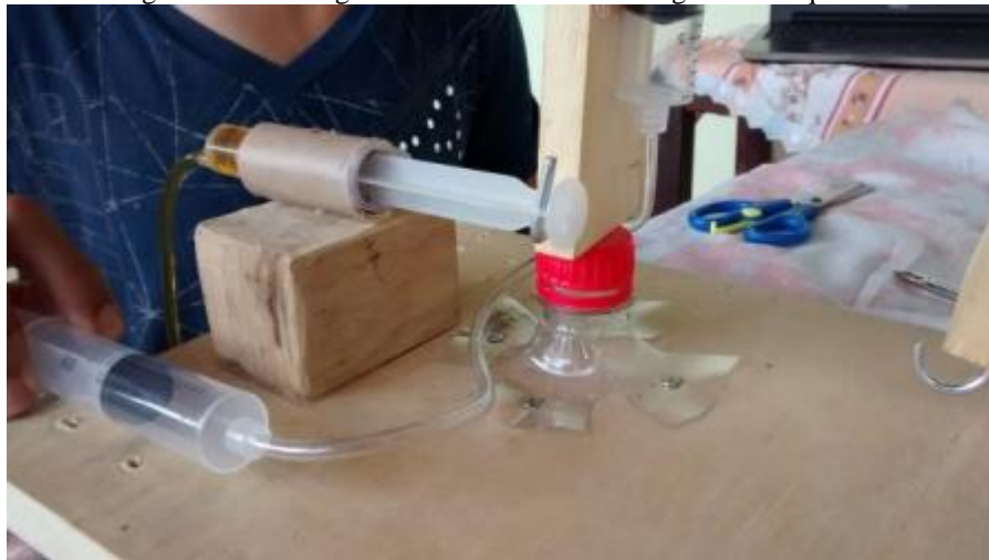
Figura 4.15 - seringas sendo unidas com a mangueira de aquário.
