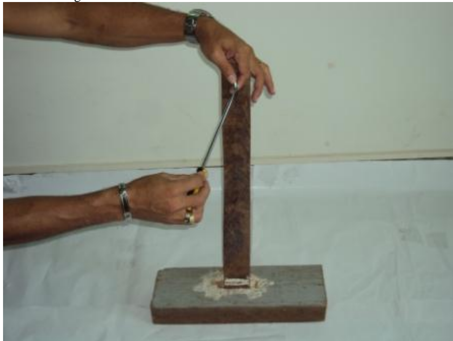
Figura 6.4 - Parafuso sendo inserido na extremidade da haste.
