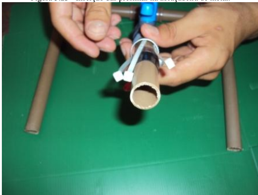
Figura 5.23 - Inserção das presilhas na abraçadeira de metal.
