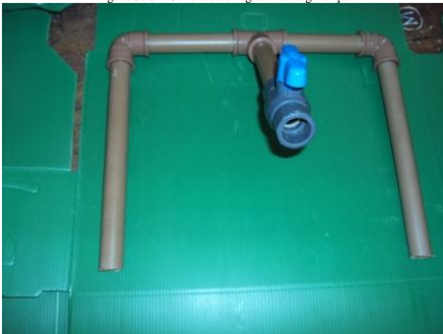
Figura 5.19 - Conexão do registro de segurança.
