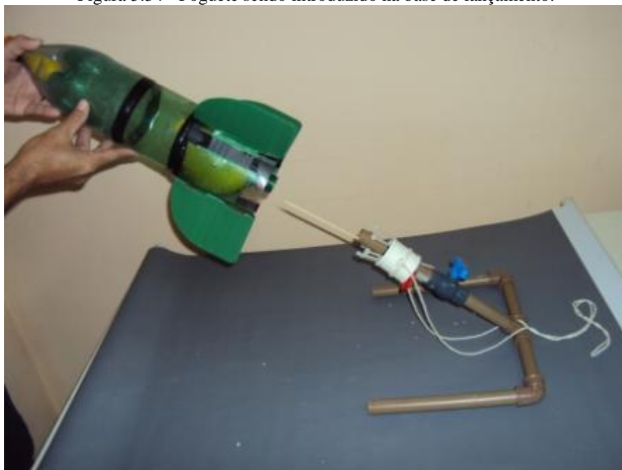
Figura 5.34 - Foguete sendo introduzido na base de lançamento.
