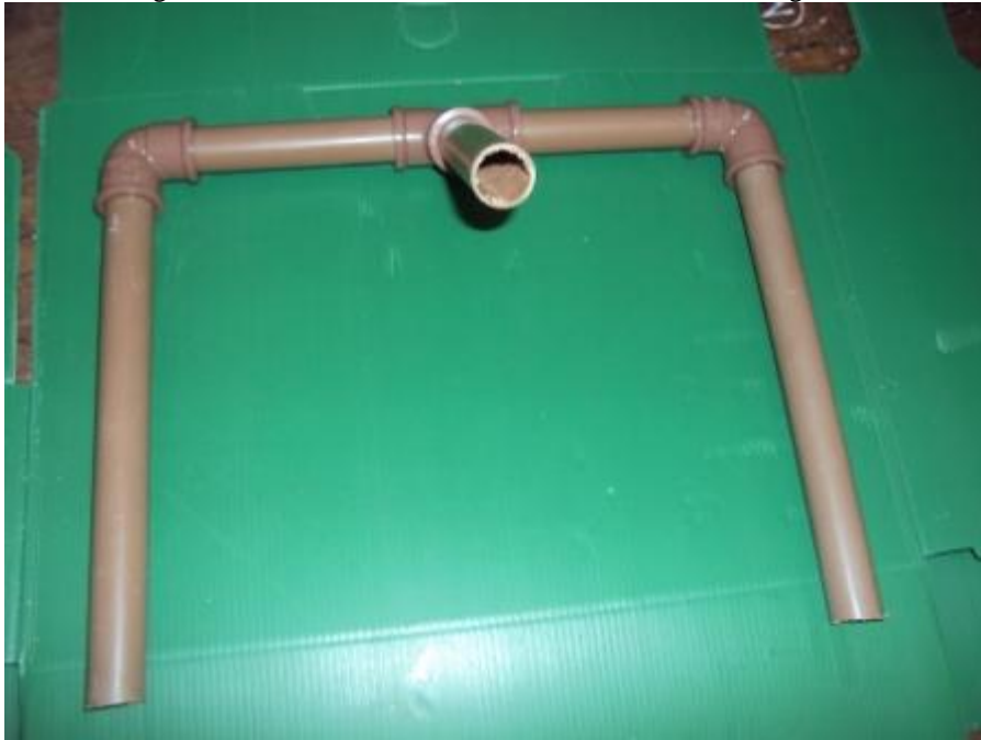
Figura 5.18 - Conexão do cano onde será encaixado o foguete.
