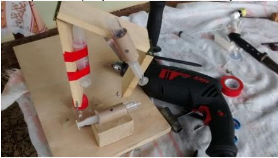
Figura 4.13 - Braço do guindaste sendo conectado à base do operador.
