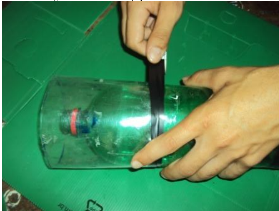
Figura 5.12 - Encaixe da peça onde será fixada as aletas.
