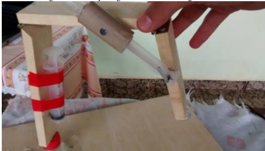
Figura 4.11 - Braço do guindaste com as seringas fixadas.
