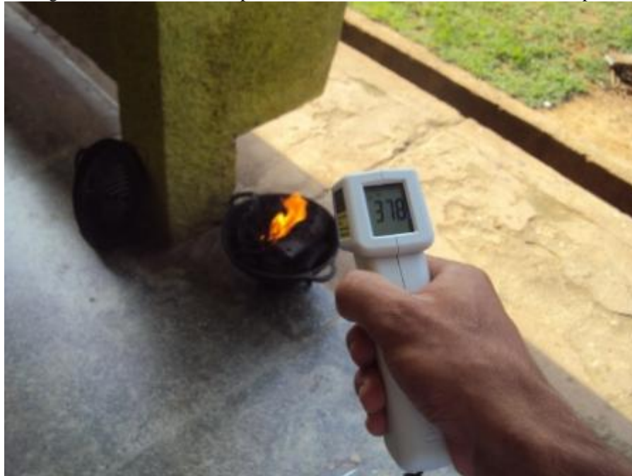
Figura 7.5 - Medindo a temperatura do carvão em certo intervalo de tempo.
