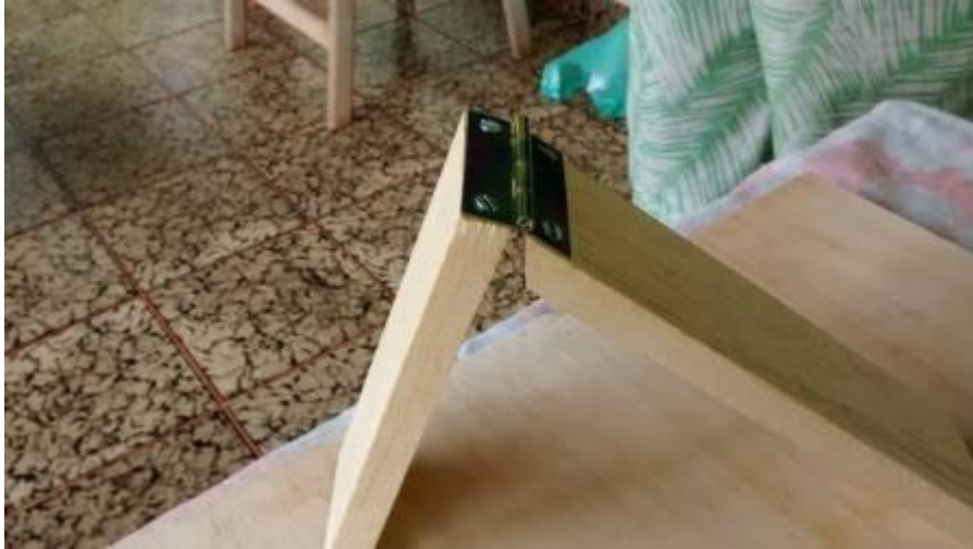
Figura 4.4 - Madeira de 15 cm e madeira de 20 cm com um chanfrado na ponta unidas.
