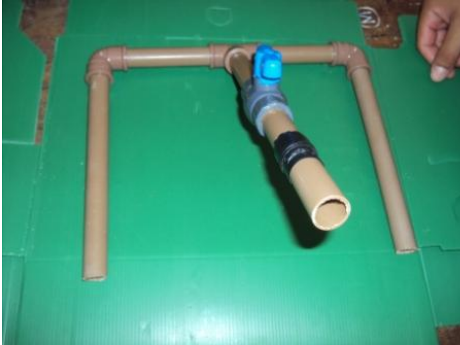
Figura 5.20 - Conexão do último cano no encaixe do foguete com a fita isolante enrolada.
