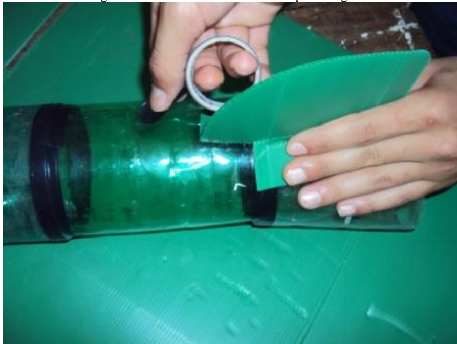
Figura 5.13 - Fixando as aletas no corpo do foguete.
