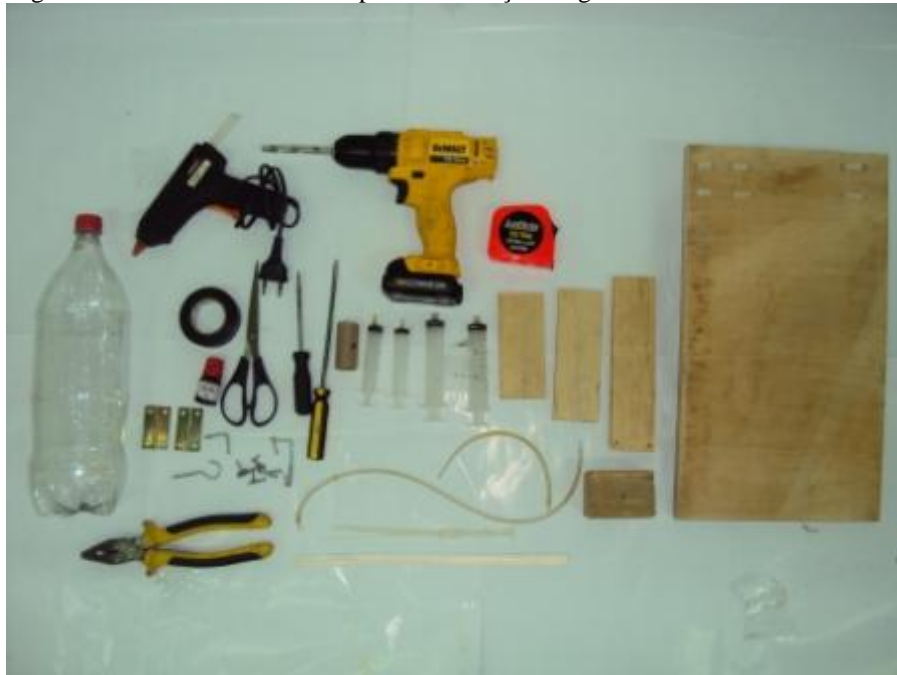
Figura 4.1 - Materiais utilizados para a confecção do guindaste hidráulico.
