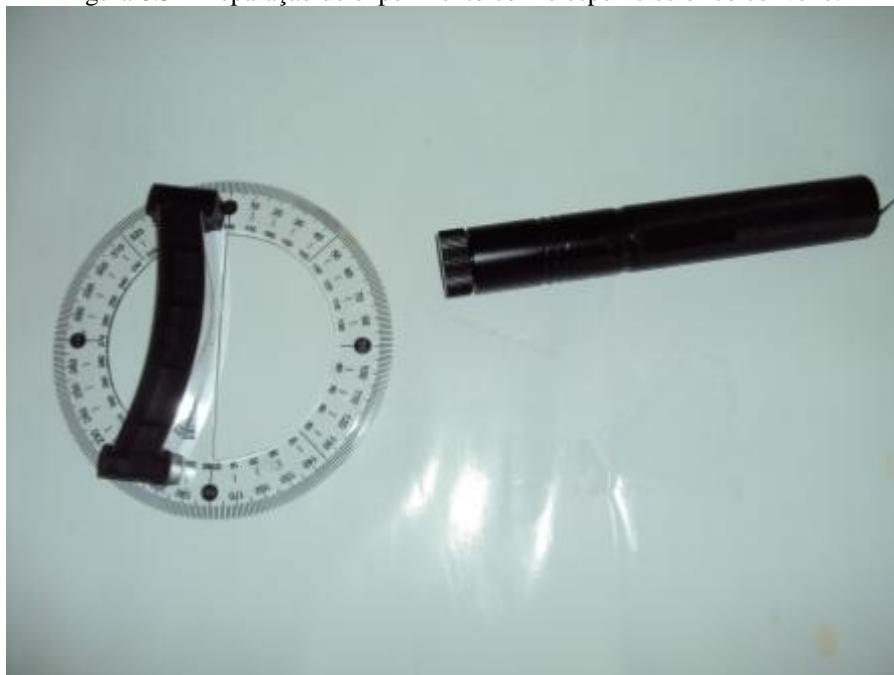
Figura 8.3 - Preparação do experimento com o espelho esférico convexo.
