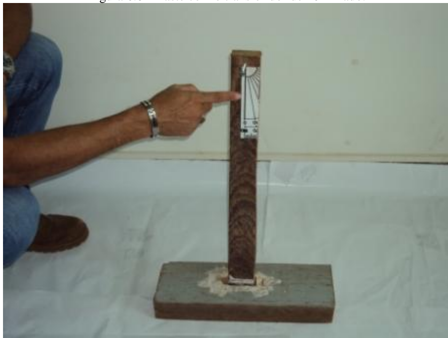
Figura 6.8 - Haste com o transferidor de 10° fixado.
