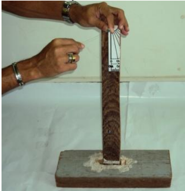
Figura 6.11 - Amarrando o conjunto linha - chumbada na haste do pêndulo.
