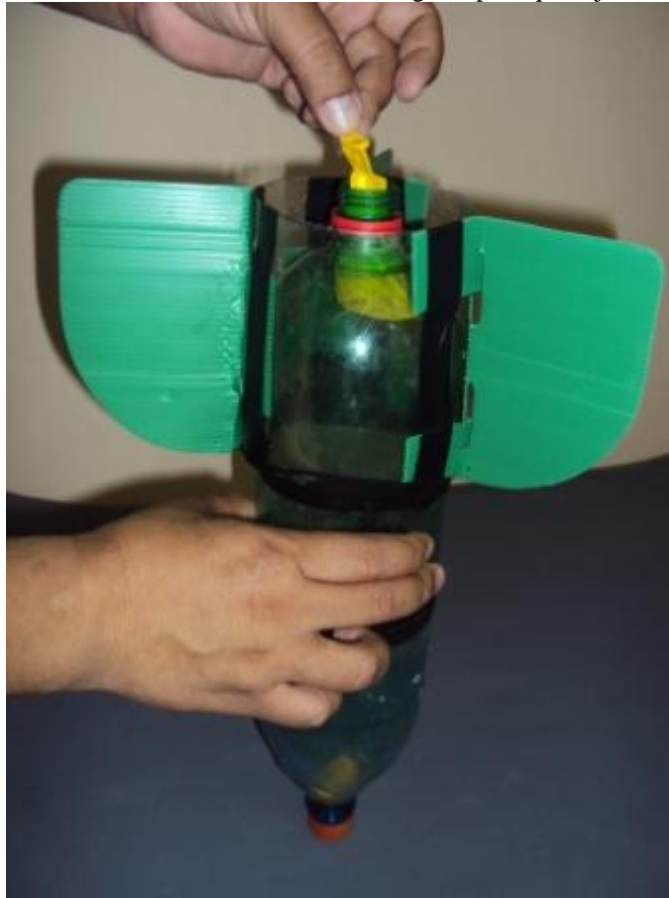
Figura 5.30- Balão sendo colocado no interior do foguete para que seja inserido o vinagre.
