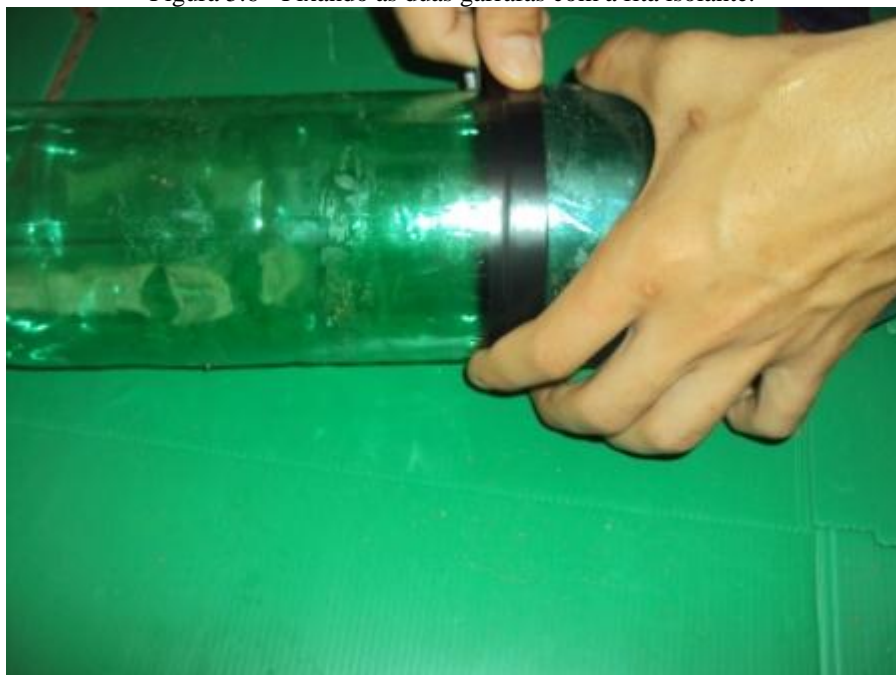
Figura 5.6 - Fixando as duas garrafas com a fita isolante.
