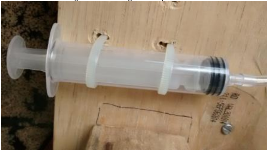
Figura 4.14 - Seringas sendo presa à base.
