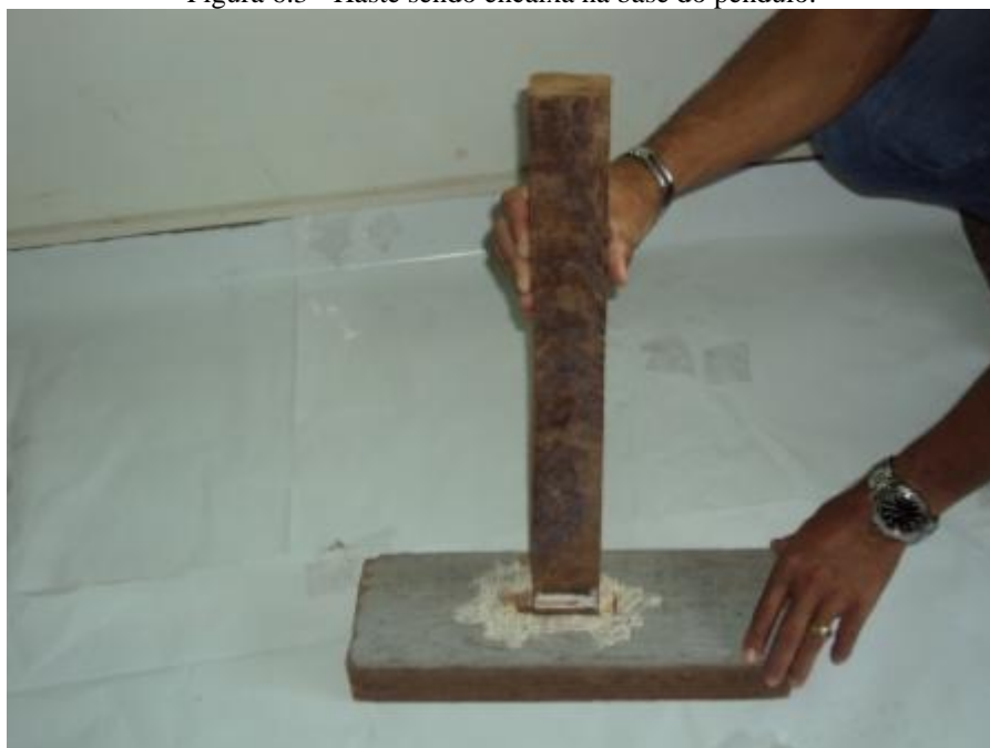
Figura 6.3 - Haste sendo encaixa na base do pêndulo.
