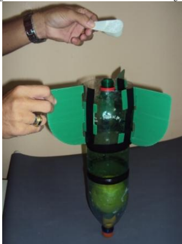
Figura 5.32 - bicarbonato sendo colocado dentro do foguete.
