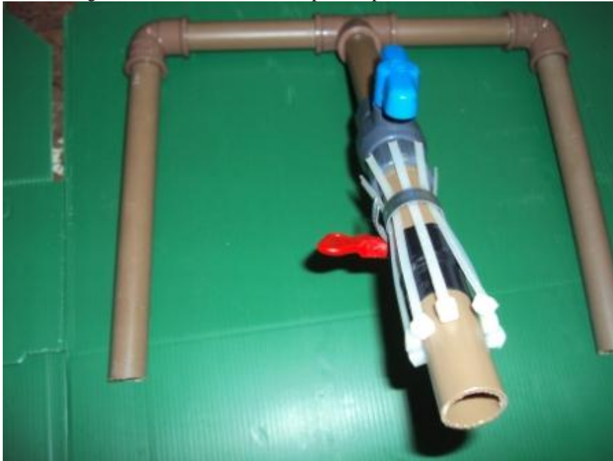
Figura 5.24 - Presilhas inseridas por completo em torno do cano.
