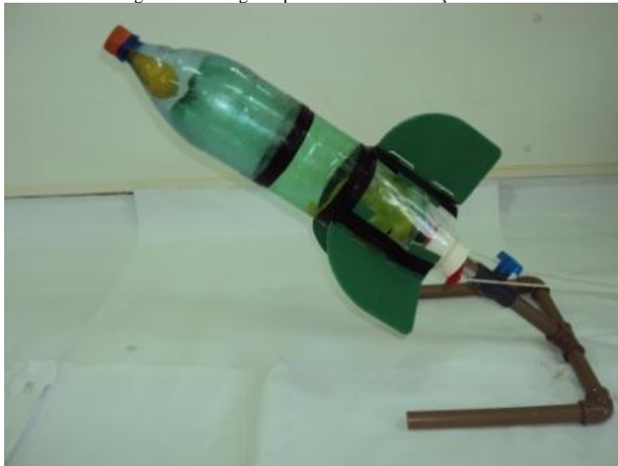
Figura 5.26 - Foguete pronto na base de lançamento.
