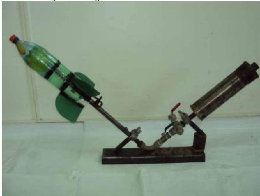
Figura 5.27 - Foguete na base alternativa feito de metal.
